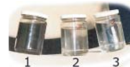
Ситуация до установки прибора (стакан 1): - Strongly загрязненная вода в нагревательном контуре - !4-дневный интервал между чистками теплообменника
